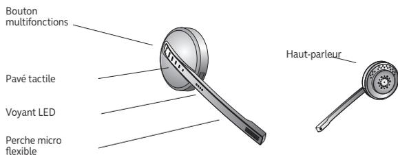
Les modèles Jabra PRO 9465, 9460 et 9450 disposent d'une perche micro flexible qui vous permet d'ajuster le positionnement du microphone. Le Jabra PRO 9470 est proposé en version mono.
