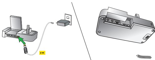
Support de connexion avec adaptateur secteur fourni. Recharge du micro-casque en mode connexion.
